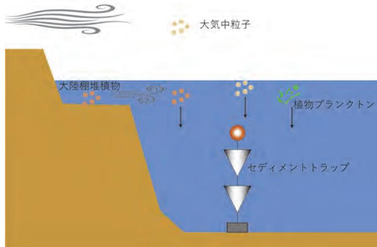
図 1. 沈降粒子とそのサンプリング
