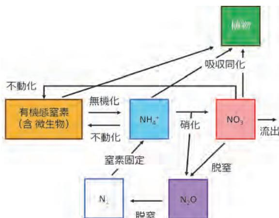
図1. 窒素循環の概略図。環境中で有機物に含まれる窒素（有機態窒素）は分解（無機化）されアンモニウムイオン ( $\text{NH}_4^+$ ) に、さらに硝化菌という特殊な微生物により硝酸イオン ( $\text{NO}_3^-$ ) に変換される。アンモニウムイオン、硝酸イオン、そして一部の有機態窒素は植物や微生物に取り込まれる（吸収同化、特に土壤微生物による吸収同化を不動化と呼ぶことがある）。酸素の少ない環境では酸素ガスの代わりに硝酸イオンを用いた呼吸を行ひ、一酸化二窒素 ( $\text{N}_2\text{O}$ ) や窒素ガス ( $\text{N}_2$ ) を放出する脱窒という作用がある。また大気中の窒素は窒素固定を行う微生物によってこの循環系に取り込まれる
