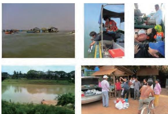
図 3. 湖の水上家屋（左上）。湖内は漁船で調査した（右上）。河川は岸辺から採水した（左下）。水試料はフィルターで懸濁物をろ過除去後（右下）、元素濃度を分析した。
