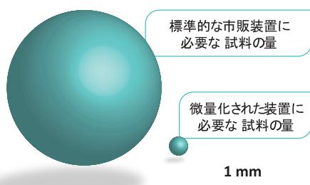
図 3. 標準的な装置と微量量化された装置で必要な試料の量の比較
