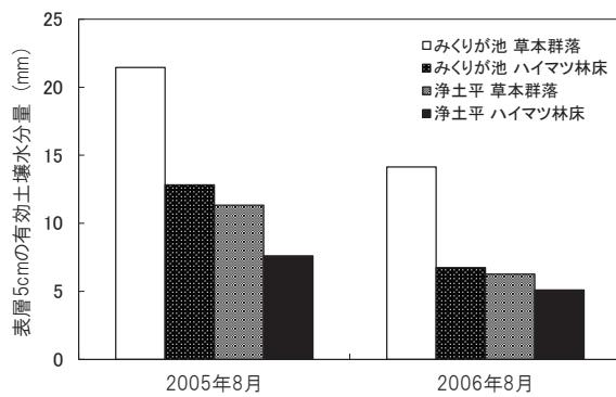
図 4. 立山高山帯の 2005 年と 2006 年の表層土壤の水分量。ADR 土壤水分センサーで測定 (Delta-T 社、ML2x)
