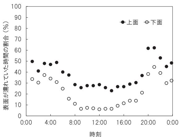
図 5. 浄土平で 8 月に表裏 45 度傾けて設置した濡れセンサーの測定結果
