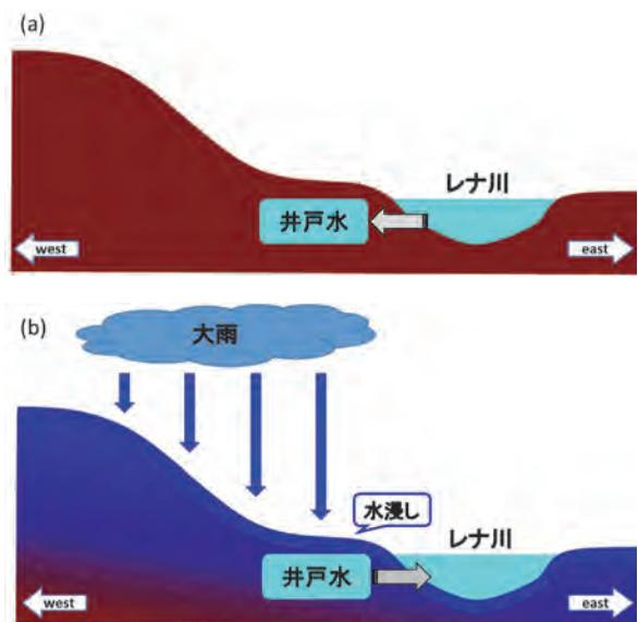
図 5. レナ川流域の断面図、通常の水の移動 (a) と 2006 年の大暴雨後の水の移動 (b) (鷹野卒論より一部改変)
