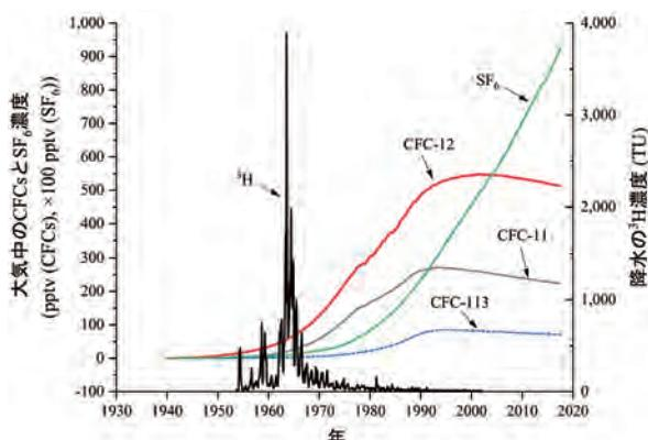
図 4. 降水の  ${}^3\text{H}$  濃度、大気中の CFCs および  $\text{SF}_6$  濃度の経年変化 (薮崎, 2021 の図を一部加筆・修正)
