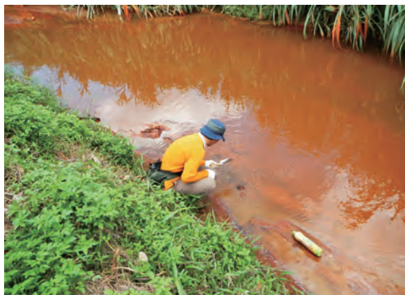
図2. マレーシアにあるチタン精錬所の残渣堆積場からの漏洩水が混入した河川。鉄水酸化物のナノ粒子が沈殿している。
